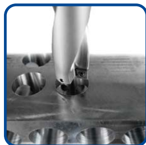
Foratura dal pieno Solid drilling
